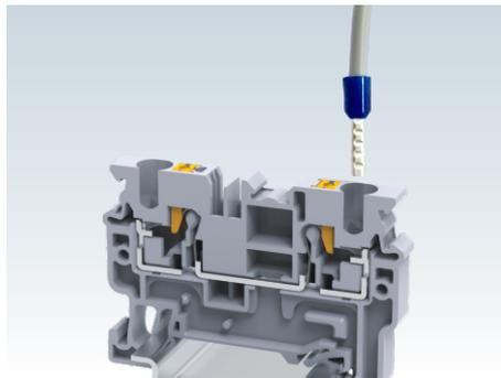
Cabos flexíveis crimpados e condutores rígidos são simplesmente introduzidos no ponto de conexão, sem necessidade de ferramenta. A mola atua com mínima força de inserção. Cabos flexíveis sem terminal necessitam que se mantenha pressionado o botão no topo do conector enquanto o condutor é introduzido.
